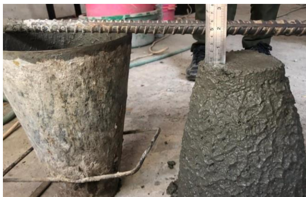
Gambar 1. Pengujian nilai slump
