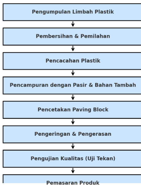
Gambar 3. Diagram alir proses produksi paving block berbahan limbah plastik.
